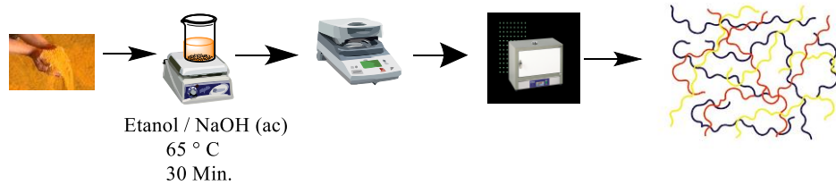
Fig 4 : Esquema del proceso de gelificación del síntesis.
